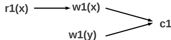
Dans une transaction, deux opérations (**p** et **q**) sur la même donnée (**x**) doivent toujours être en relation :  $p(x) < q(x)$  ou bien  $q(x) < p(x)$
